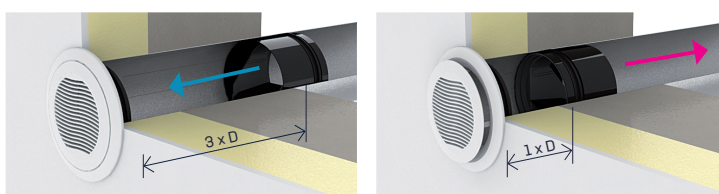
BORÉA avec régulateur RDR en soufflage
