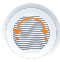
Ouverture (+) ou fermeture (-) de la grille
